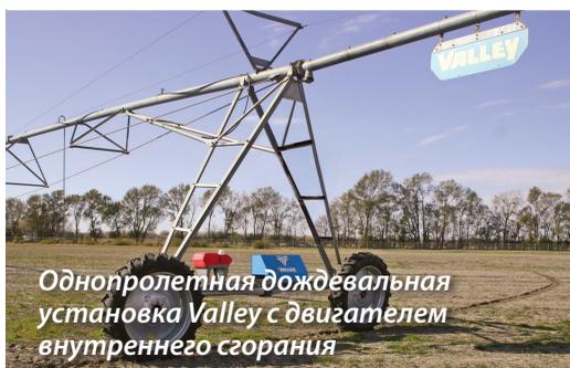
*Однопролетная дождевальная установка Valley с двигателем внутреннего сгорания*
